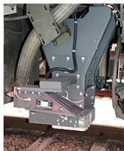
ETCS-Antenne einer ÖBB 1116
