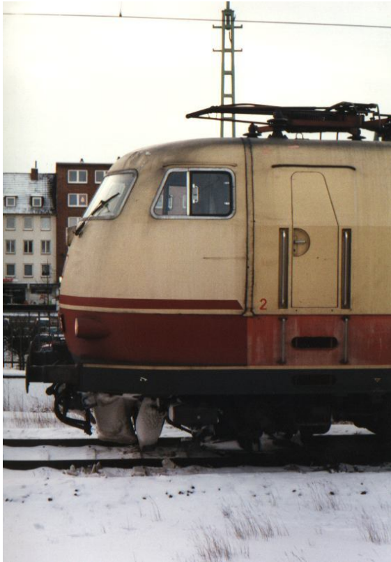
Kopf der 103 133 in Bremerhaven 1999 (hier ohne Schürze unterhalb der Puffer oder Kupplung)
