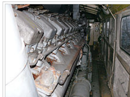
Dieselmotor 5D49 vom Führerstand 2 aus gesehen. Blick auf Zylinderseite A
