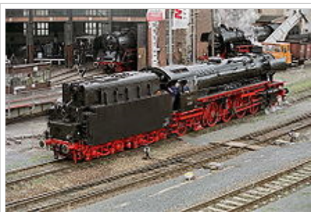
41 360 des Dampfloktadition Oberhausen e.V. mit dem charakteristischen Tender der ölgefeuerten Lokomotiven
