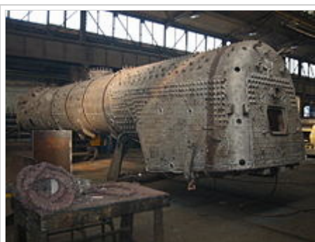
Verbrennungskammerkessel Bauart 39E (Meiningen, 2003)
