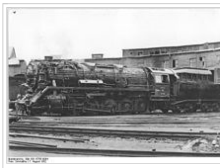
Auf Kohlenstaubfeuerung umgebaute 44 392 der Reichsbahn in der DDR (1952)
