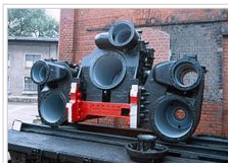
Zylinderblock der Baureihe 44, rot gestrichen: ein Abschnitt des Barrenrahmens
