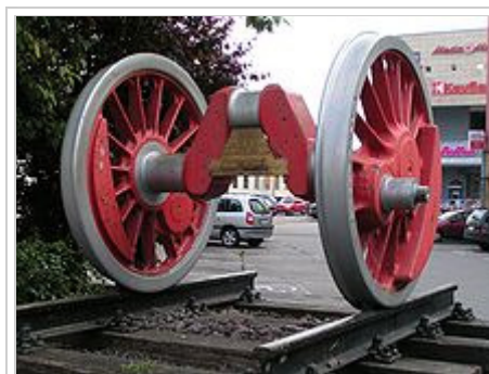
Treibradsatz der Baureihe 44 (zweiter Kuppelradsatz mit Kropfwelle)
