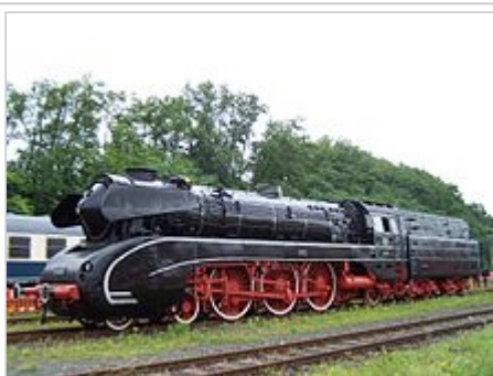
10 001 von der Heizerseite aus gesehen, man beachte Gegenkurbel und Schwingenstange am dritten Kuppelradsatz
