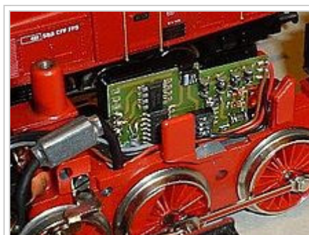
Märklin-Delta-System-Decoder mit Zusatzfunktion (Märklin-Artikel 66031)
