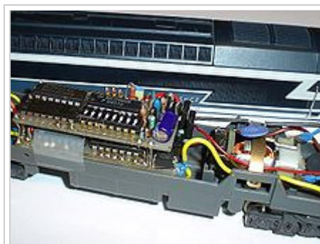
Durch einen Studenten gebauter Decoder für das Märklin-Digital-System vom März 1986.
