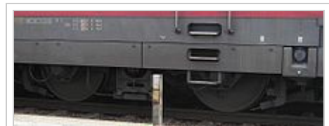
Drehgestell der Baureihe 101 mit großen Rädern und kurzem Radsatzabstand
