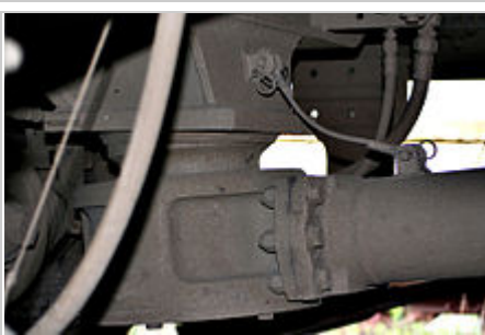
Anlenkung des Drehgestellrahmens (oben links) mittels Zug-/Druckstange (unten, von rechts kommend) bei der Baureihe 101
