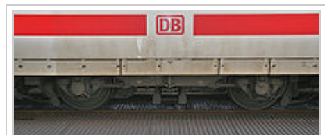
Drehgestell des ICE 1 mit dem größeren Radsatzabstand und den kleineren Rädern
