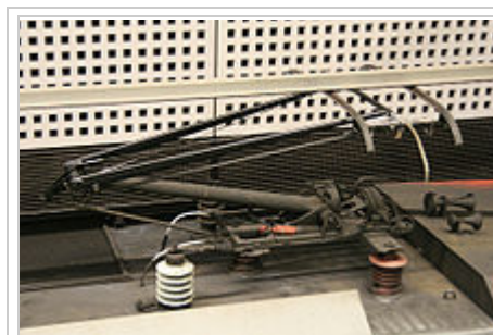
Stromabnehmer des Typs DSA 350 SEK der Baureihe 101
