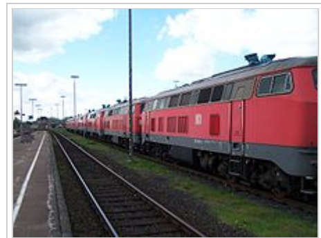
Loks der Baureihe 218 stehen in Niebüll auf dem Abstellgleis und warten auf eine Verwendung. Gegen zu viel Feuchtigkeit in den Motoren wurden die Auspuffhutzen mit Müllsäcken abgeklebt.
