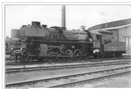
Rückgebaute 52 Kon bei der DR, die Saugzugturbine ist erkennbar
