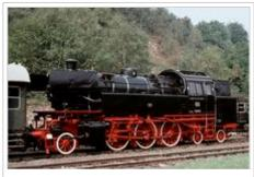
DB-Baureihe 66 mit seitlichen Wasserkästen und Kohlenkasten hinter dem Führerhaus
